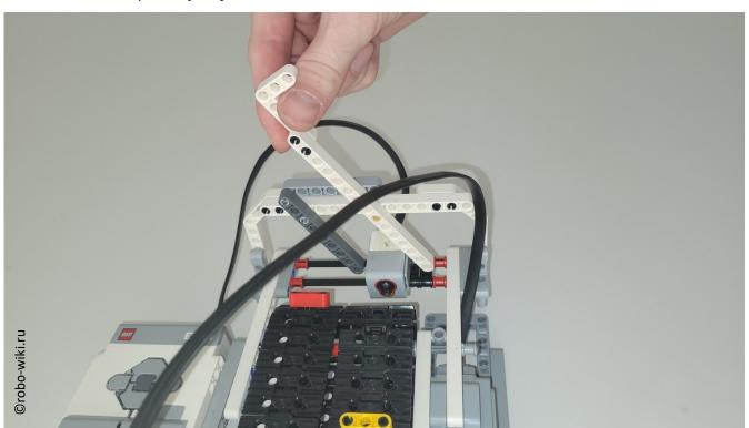
Датчик скользит по двум направляющим осям. Если оси кривые, попробуйте выправить их или найдите аналогичные из другого набора. Перемещайте датчик только с помощью рычага.
